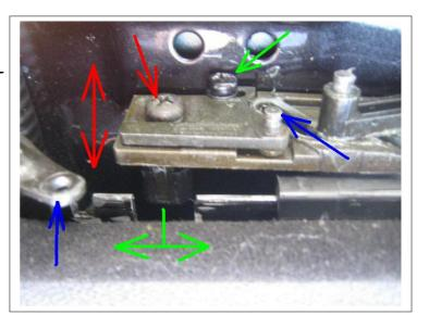
Jetzt das SSHD mehrmals "öffnen und schließen" sowie "heben und schließen" und dabei immer wieder überprüfen, ob das geschlossene SSHD bündig im Autodach liegt. Gegebenenfalls mit den Verstellschrauben nachjustieren.
