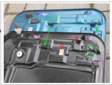
Position der Halter (grün) angezeichtnet und der Abstand zum Deckel seitlich gemessen. Diese Schablone wird auf dem SDD-Deckel ausgerichtet und fixiert.
