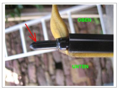
Beim Einsetzen des SSHD darauf achten, dass die zwei Führungsschienen genau an der Wulst (blau) jeweils rechts und links anliegen. Nur so ist es gewährleistet, dass die zwei Führungsdorne in die Arretierungslöcher hinten im Dach hineingleiten. Diese Löcher sind nämlich nicht einsehbar.
