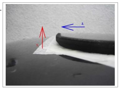
Danach das SSHD von außen nur noch anheben und nach vorne herausziehen. Dabei die Seilzugführung (roter Pfeil) anheben, so dass dieser nicht auf dem Dach schleift.
