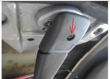
Unter der Kurbel befindet sich das Seilzuggetriebe, welches mit den 2 Kreuzschrauben (blau) abgenommen wird
