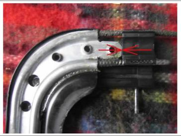
Danach wieder die Kurbel und das Seilzuggetriebe montieren. So lange das nicht montiert ist, können sich die Züge wieder verschieben.
